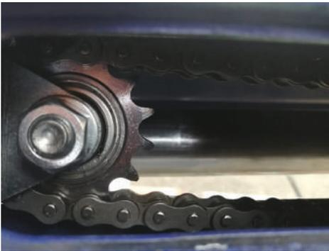
Le guide coulissant cylindrique est durci et cémenté, les bagues sont frittées pour assurer une résistance et une **durabilité maximales**.
