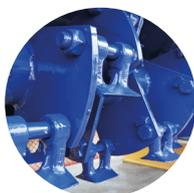
Tutti gli attacchi di collegamento sono fatti sulla valvola di serie e non sul motore.
